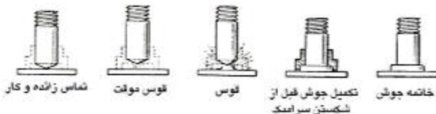
شکل ۱-۷۲- مراحل عملیات جوشکاری زائده ای
