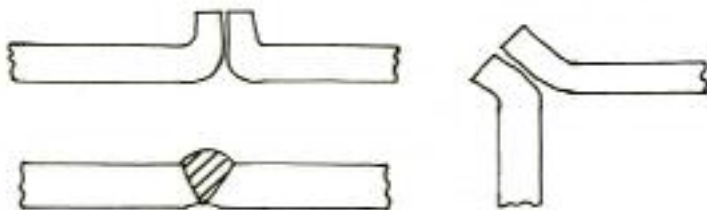
شکل ۱-۶۴- نمونه ای از طرح اتصال ورقهای نازک برای جوشکاری TIG بدون نیاز به مفتول
