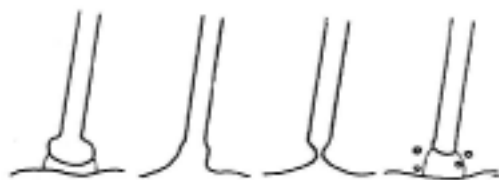
شکل ۱-۱۸- مکانیسم های انتقال قطرات مذاب از الکتروود به حوضچه جوش (a) پرواز آزاد (b) مدار بسته
